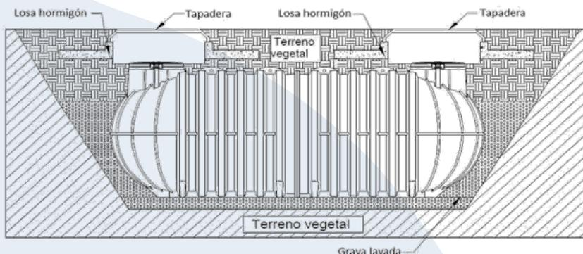
Ilustración VI: Colocación de pozos de registro con losa de hormigón.
